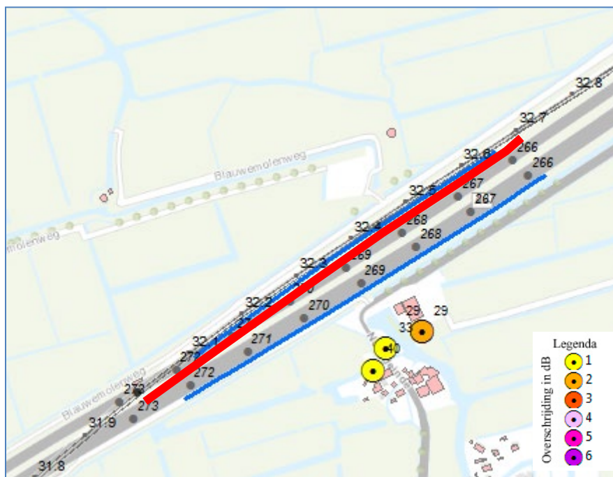
Figuur 13: Maximale maatregelen bij het Noordeinde te Hoogmade. Raildempers tussen km 32,0 en 32,7.
