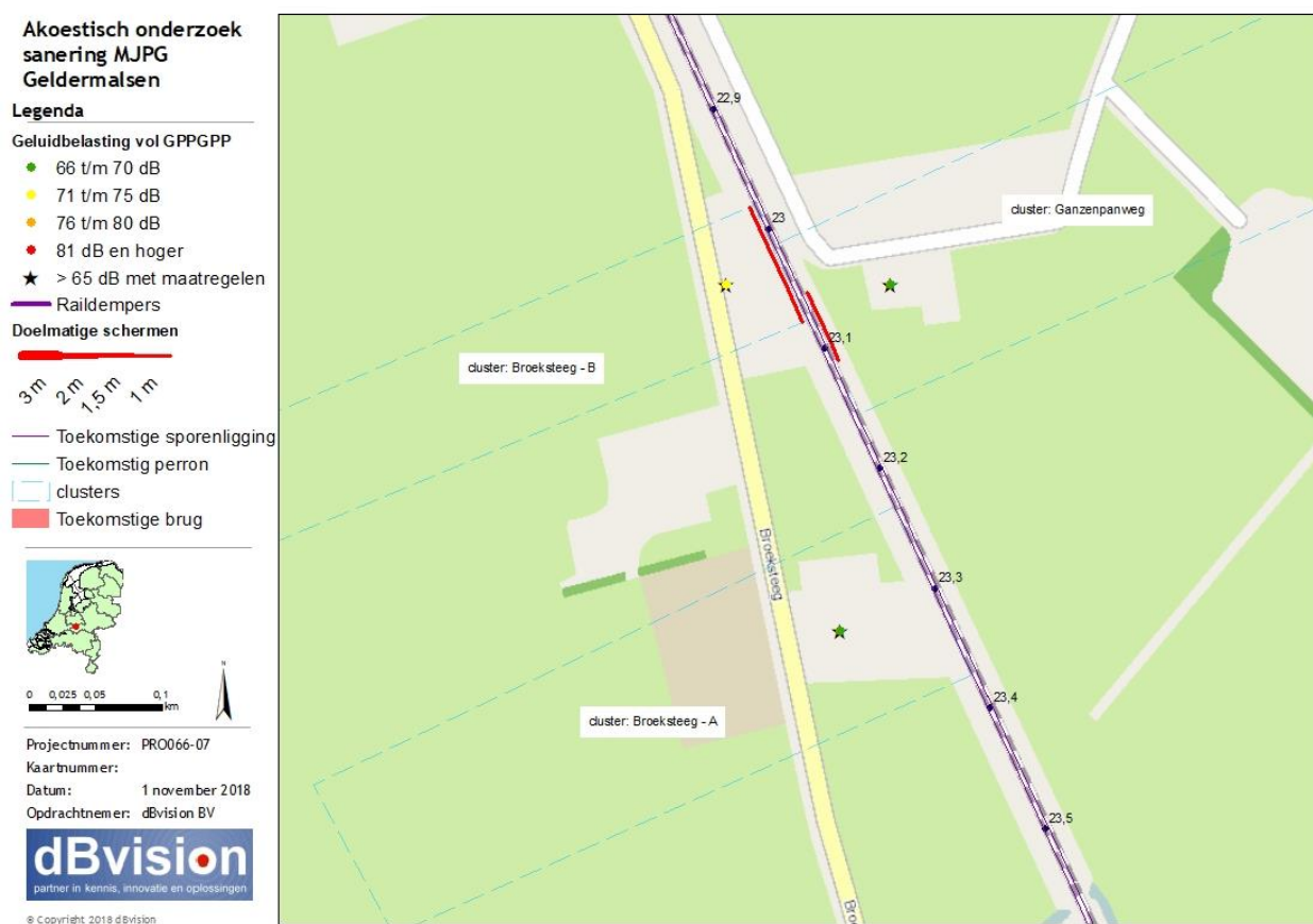
Figuur 13 Cluster Broeksteeg-A, Broeksteeg-B en Ganzenpanweg. Een ster betekent dat de woning in de eindsituatie een overschrijding van de streefwaarde heeft.
