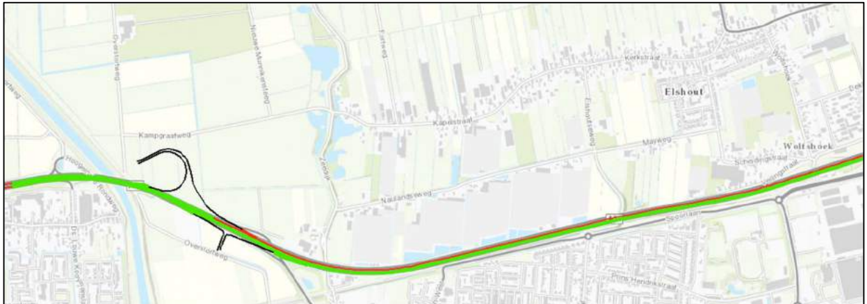
Figuur 4.3a: Inzet van tweelaags ZOAB weergegeven door een groene kleur om GPP-overschrijdingen te voorkomen ter hoogte van aansluiting 40 en Drunen
