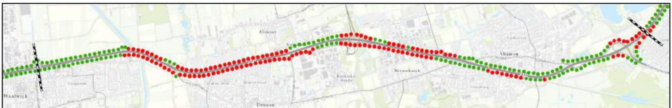
Figuur 4.2: Locaties waar de geluidproductieplafonds worden overschreden zijn weergegeven door een rood bolletje bij Stap 1a
