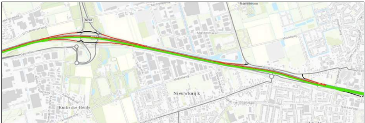
Figuur 4.3b: Inzet van tweelaags ZOAB weergegeven door een groene kleur om GPP-overschrijdingen te voorkomen ter hoogte van het "Ei van Drunen" en Nieuwkuijk
