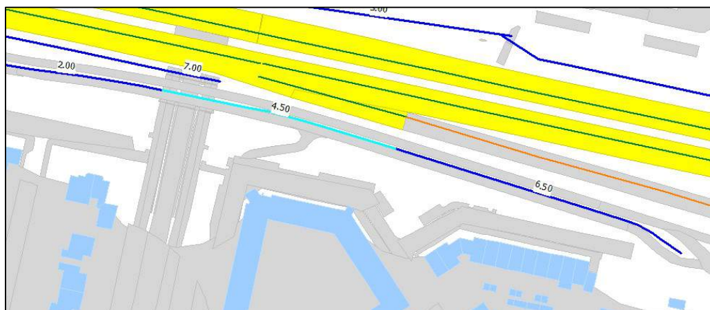
Figuur 5.4: Lichtblauw gekleurd geeft de ligging van het schermdeel met een hoogte van 4,5 meter ten behoeve van de afweging subcluster Schilderstraat
