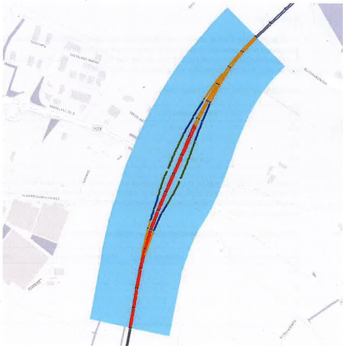
figuur 13 Toekomstige rekensnelheden binnen projectgebied (groen = 50 km/u, blauw = 65 km/u, oranje = 80 km/u, rood = 100 km/u)
