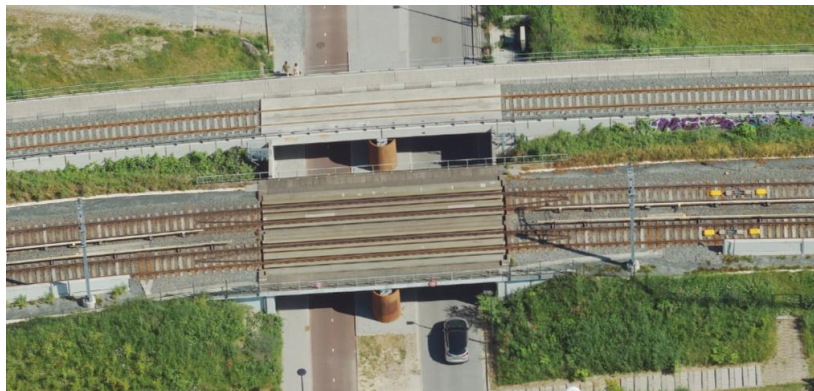
Figuur 11 Vaste stalen brug (10 dB toeslag) over de Parkweg te Schiedam (2 sporen onder in beeld).
