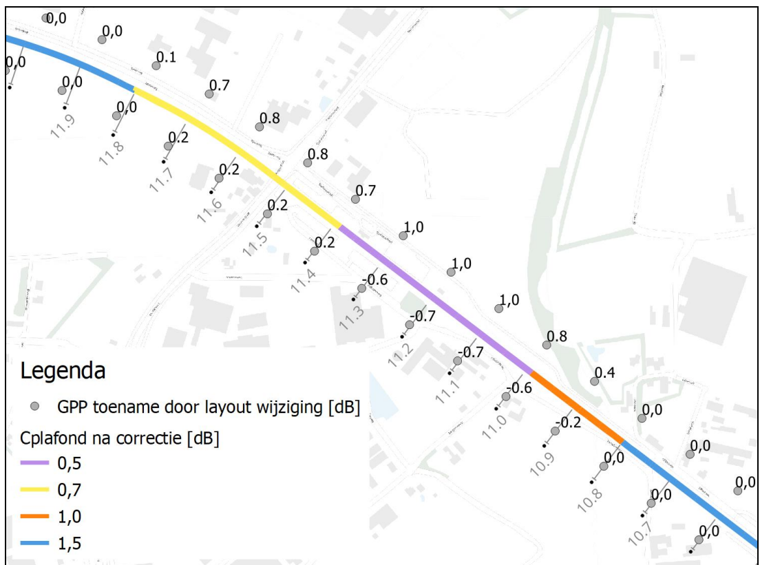
Figuur 9 Effect van de gewijzigde sporenligging op de geluidproductie en de waarde van C_{\text{plafond}} na correctie.
