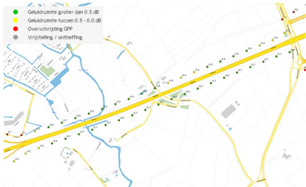
Figuur 7 Overschrijdingen (rode bolletjes) en dreigende overschrijdingen (gele bolletjes) van de geluidproductieplafonds bij de naleving 2019 bij knooppunt Werpsterhoek (middelste deel)
