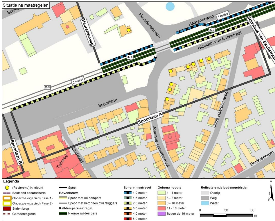
Figuur 16 Geluidbeperkende maatregelen voor cluster Spoorlaan A
