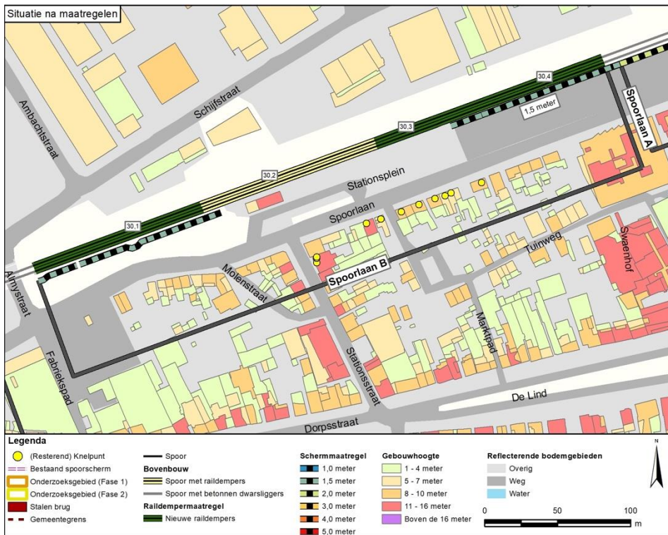
Figuur 17 Geluidbeperkende maatregelen voor cluster Spoorlaan B
