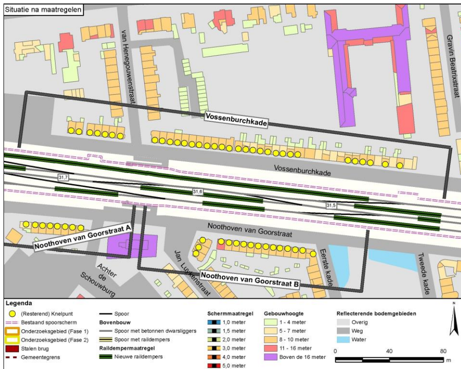
Figuur 11 Geluidbepenkende maatregelen voor cluster Vossenburchkade
