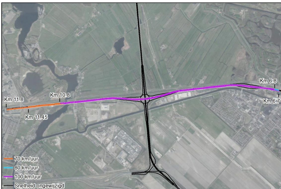
Figuur 2: Wegvakken van de A200/N200 met aangepaste snelheid tussen km 6.7 en km 11.8
